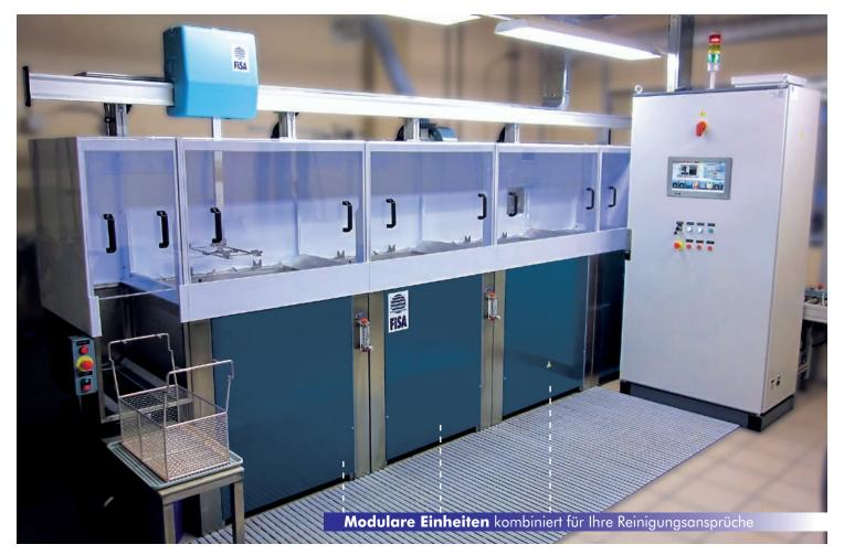
Die modulare C40 Anlage vereint die besten technologischen Lösungen in einem einfachen und flexiblen Konzept. Es handelt sich hierbei um Einzelmodule, die beliebig kombiniert werden können, je nach ausgewähltem Prozess. Die Flexibilität der C40 ermöglicht Ihnen alle Funktionen zu kombinieren: Be- und Entladen, Ultraschallreinigung mit Reiniger, Spülen mit Stadtwasser, Spülen mit VE-Wasser und Heißlufttrocknung. Wir garantieren Aufbau und Inbetriebnahme der Anlage in nur wenigen Stunden.
