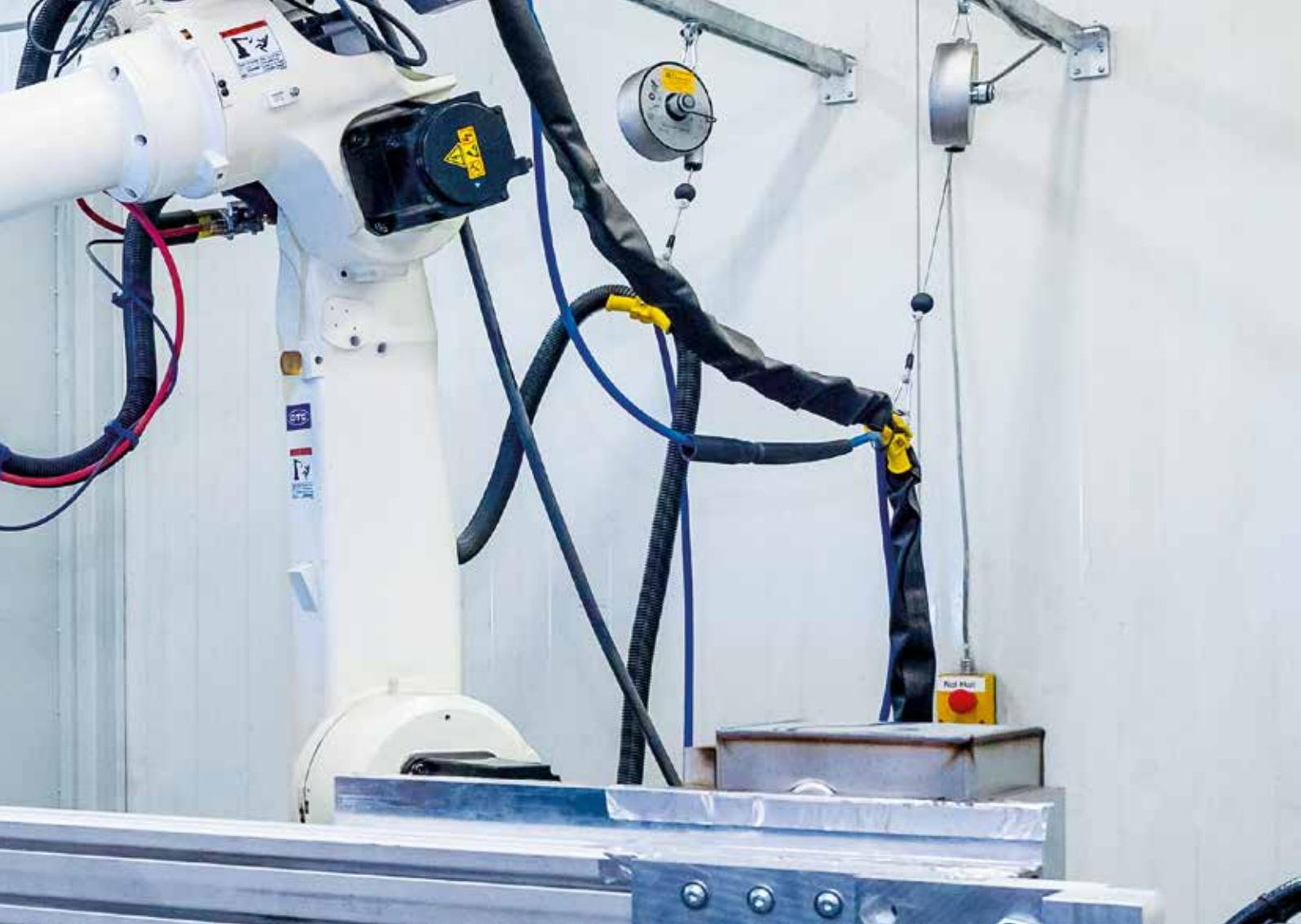
Bei größeren Stückzahlen bzw. bei der Umsetzung von Rahmenaufträgen favorisieren wir das Roboterschweißen. Hier verfügen wir über einen Roboterarm mit 2.000 mm Länge.
