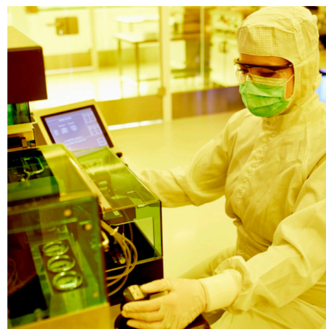
Fotolithographie-Prozess im Reinraum
