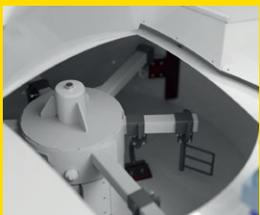
Die entsprechende Betonsorte wird vollautomatisch im Mischmodul der Anlage in ca. 2–3 Minuten gemischt und anschließend mit Hilfe des Förderbandes zum Fahrzeug gebracht.
