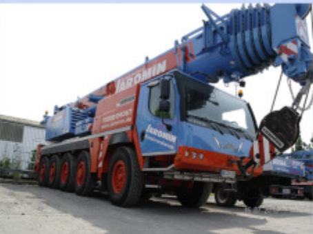
Liebherr Teleskop-Autokran der 120 t-Klasse mit hervorragenden Traglastwerten..
