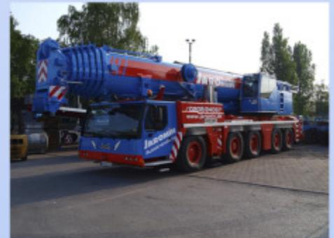
Ein moderner Liebherr Telekran der 200-t Klasse, sein 72 m langer Ausleger, kann durch Anbau einer 22m langen Kranspitze eine Hakenhöhe von 88 m erreichen.
