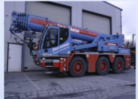
Sehr kompakter Teleskop-Autokran mit einem 36 m langen Teleskop-Ausleger mit herausragenden Traglasten. Ein besonderes Gimmick ist seine um 8,2 m hochfahrbare Krankabine, welche dem Kranfahrer einen exzellenten Überblick über dem Hebevorgang ermöglicht.
