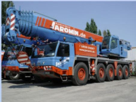
Dieser Teleskop-Autokran aus dem Hause Tadano-Faun verfügt über enorme Traglastwerten an seinem 60 m langen Ausleger. Er verfügt optional über eine 2. Winde!
