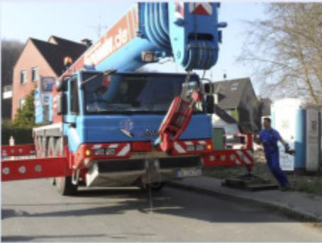
Teleskop-Autokran der 70/80 t Klasse, welcher sein Kontergewicht am Kran mitführt und deswegen keinen Anhänger braucht. Echter Taxikran, sehr schnell aufgebaut und für seine Klasse mit starker Tragfähigkeit.
