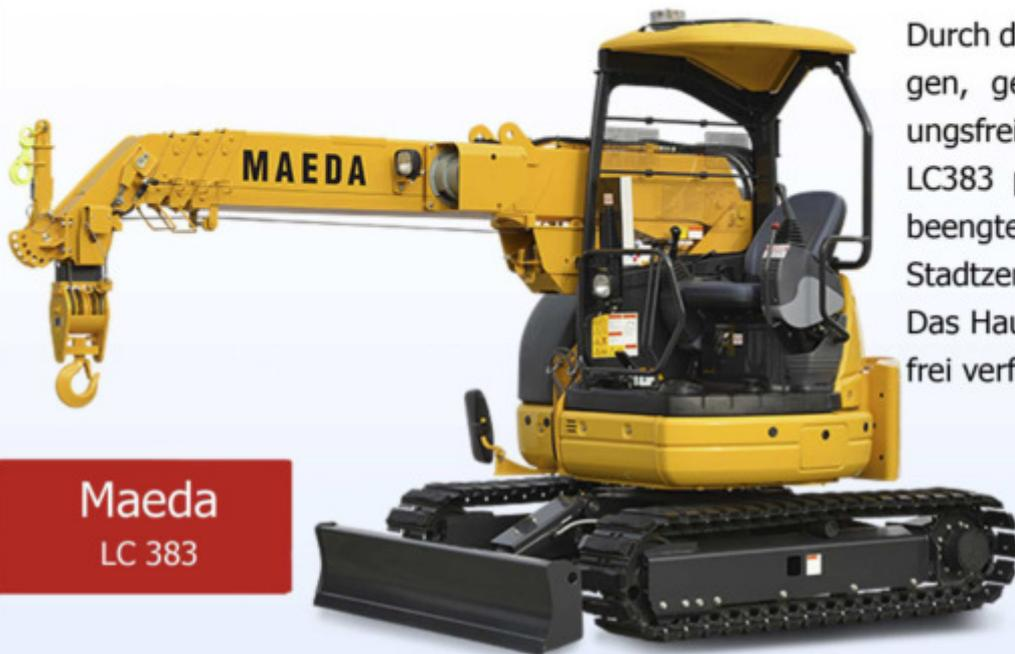
Durch die extrem kompakten Abmessungen, geringe Spurbreite und abstützungsfreies Arbeiten mit Kurzheck ist der LC383 prädestiniert für Arbeiten unter beengten Platzverhältnissen, wie z. B. Stadtzentren und ähnlichem.
