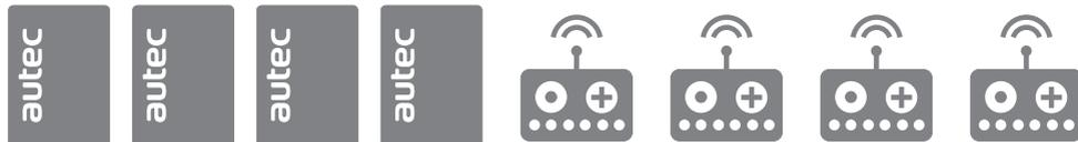
Ein Mehrfachsystem besteht aus mehreren tragbaren Sendeeinheiten (2 bis 4) über die die Bediener eine oder mehrere Maschinen fernsteuern können und aus mehreren Empfangseinheiten (2 bis 4), die an den Maschinen installiert sind. Die Sendeeinheiten können sich gleichzeitig mit allen ausgewählten Empfangseinheiten verbinden. Die Empfangseinheiten können von einer Sendeeinheit nach der anderen gesteuert werden, unabhängig und exklusiv.
