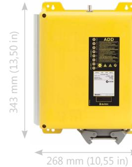
Empfangseinheit mit 16 eingebauten analogen Eingängen (Spannung oder Strom). Bis zu 12 analoge (Spannung) oder 24 analoge PWM (12 bidirektionale Achsen), bis zu 64 digitale Ausgänge, auch über CANopen Schnittstelle erhältlich. Verwendungsmöglichkeit in einem Supervisor - Operatorsystem. Verdrahtung mit 32, 40, 50, 72-poligem Stecker.
