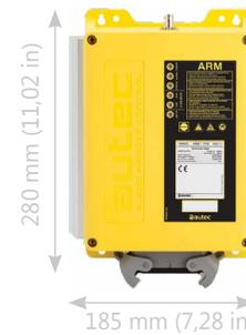
Konfigurierbare Empfangseinheit mit vorverkabelten Ausgängen: bis zu 12 analoge (Spannung) oder 24 analoge PWM (12 bidirektionale Achsen), bis zu 64 digitale, auch über CANopen Schnittstelle erhältlich. Verdrahtung mit 32-, 40-, 50-, 72-poligem Stecker. Außenantenne mit Stab.
