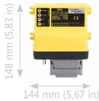
Empfangseinheit mit vorverkabelten Ausgängen: 12 analoge und 64 digitale über Schnittstelle CANopen, 4 digitale Mosfet-Ausgänge. Verdrahtung mit M12 Rundsteckverbindern oder 10-poligem Stecker in verkleinerter Version oder Kabelverschraubung. Innenantenne serienmäßig, Außenantenne optional.
