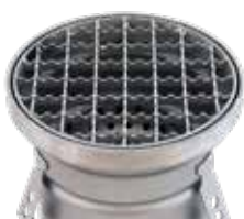
Gitterrost Maschenweite 20 x 20 mm mit Rutschhemmung Belastungsklasse: L15
