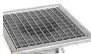
Gitterrost Maschenweite 20 x 20 mm mit Rutschhemmung Belastungsklasse: L15
