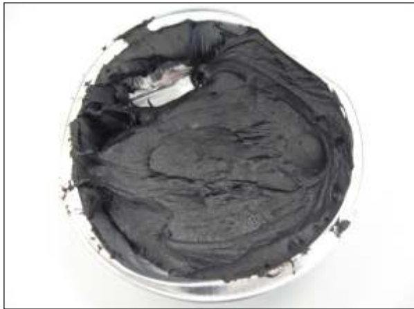
ausgehärtete i.O.-Probe, dauerelastisch (58 Shore A)
