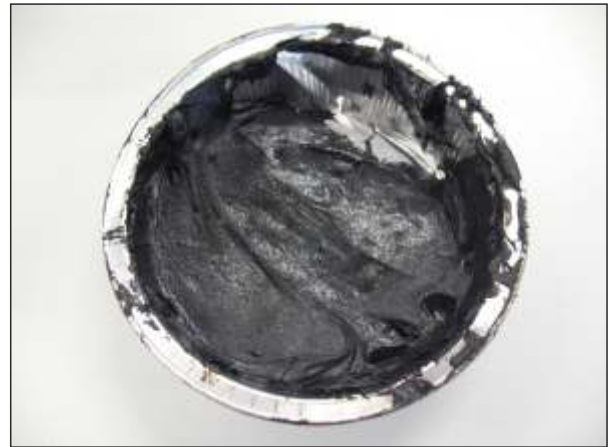
ausgehärtete n.i.O.-Probe, unelastisch (95 Shore A)
