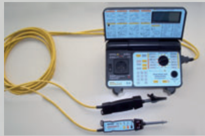
Elektrische Sicherheitsprüfung nach EN 60204 (VDE 0113)
