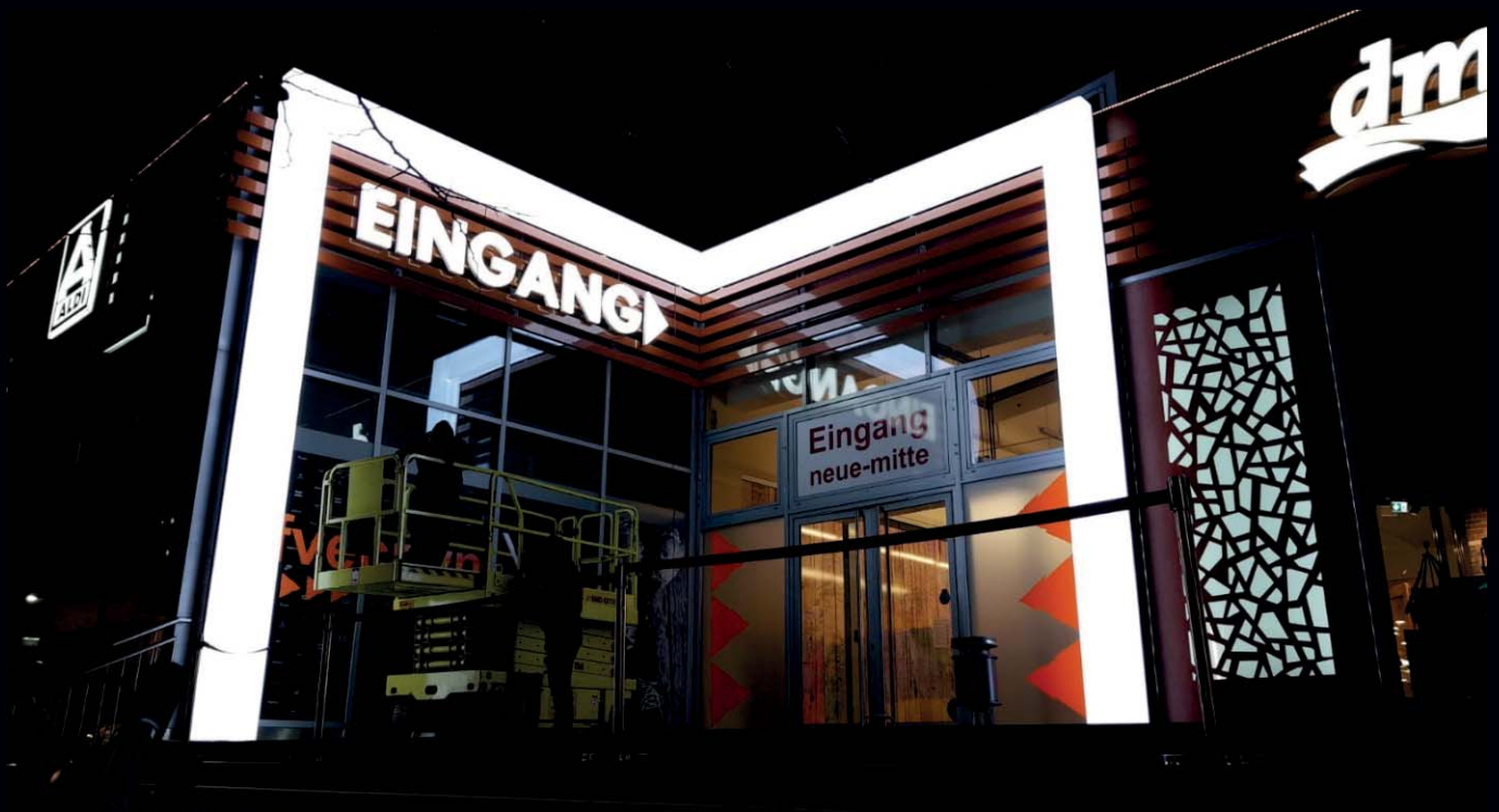
LED beleuchtetes Eingangsportal aus Polycarbonat, allseitig leuchtend. Abmessungen: 6.000 x 5.000 x 5.000 x 6.000 mm. Hier: Neue Mitte Jena
