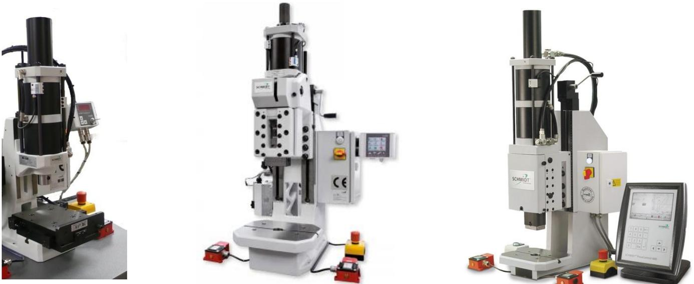
Bei der Produktfamilie **SCHMIDT® PneumaticPress** handelt es sich um ein modulares System, welches im Presskraftbereich von 1,6 bis 60 kN den Anforderungen aus den Bereichen Umformen, Fügen und Montieren optimal gerecht wird. In Kombination mit der Steuerung **SCHMIDT® PressControl 75** oder **600** werden die Pressen zu EG-baumustergeprüften, CE konformen Arbeitsplätzen, wahlweise mit Prozessüberwachung.
