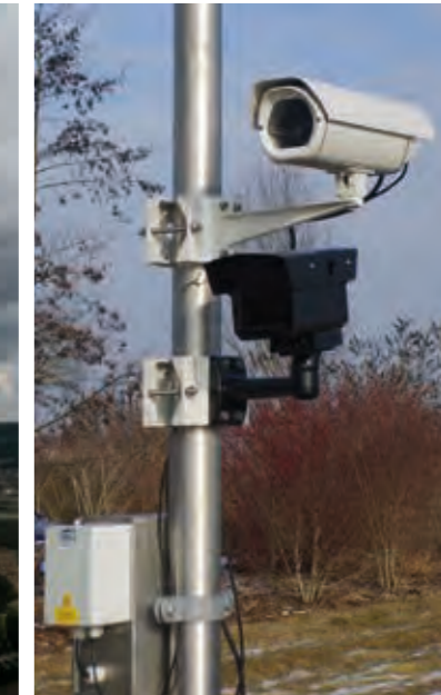
Klassische Kameras mit Wetterschutzgehäuse und Infrarot-Strahler
