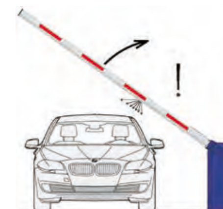
Der seitlich angeflanschte Schrankenbaum ist mit einer Sollbruchstelle ausgestattet
