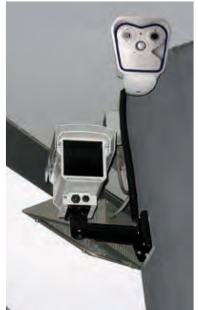
Kombination von KFZ-Kennzeichen-Erkennungskamera und Übersichtskamera
