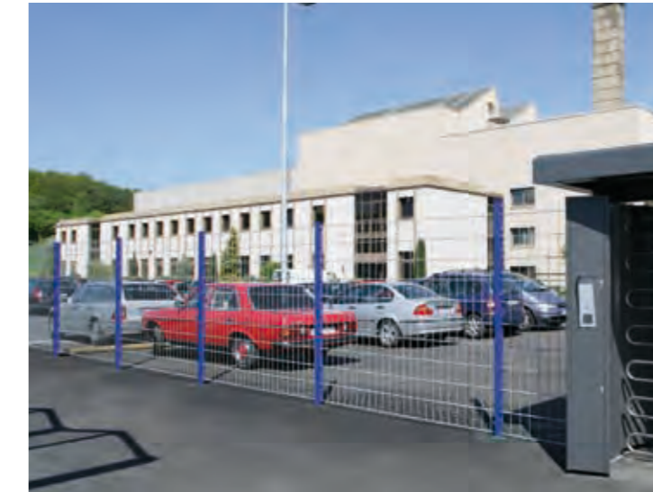
Doppelstabmattenzaun mit Maschenweite 100/200
