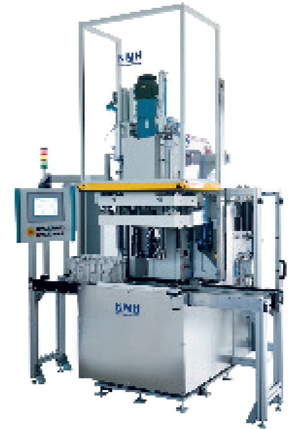
>> NMH-Elektropresse für Getriebegehäuse, montiert unterschiedliche Lager und Bolzen in unterschiedliche Getriebegehäuse in einer einzigen Anlage
