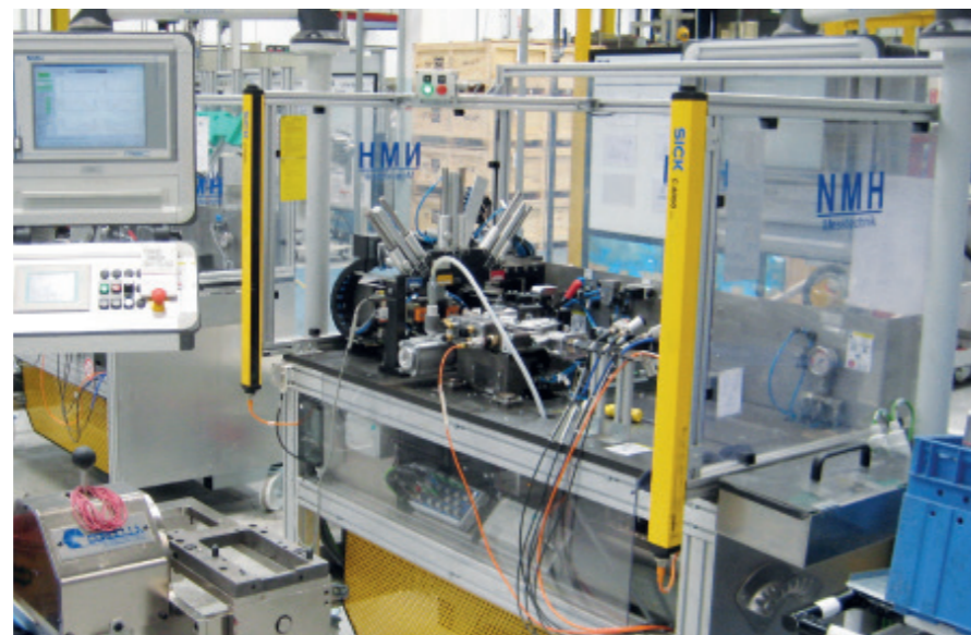
>> Messanlage zum Prüfen von Schaltauslegern im NKW Bereich
