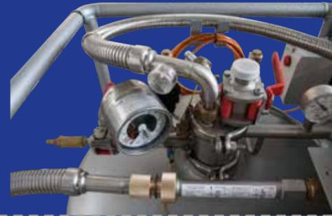
Dauerhaft installierter Heber im STRATOS®-Behälter mit patentierter Anti-Oszillations-Einrichtung:
