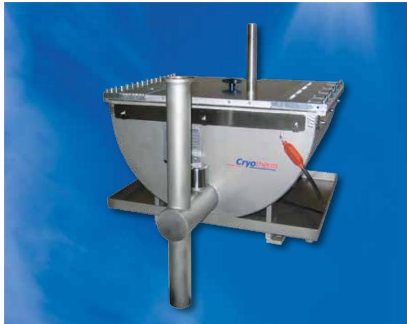
Cryotherm kooperiert mit Unternehmen des Maschinenbaus, die namhafte Automobilhersteller im In- und Ausland zu ihren Kunden zählen, und fertigt Kühlbäder mit unterschiedlichsten Geometrien, Ausrüstungsteilen und Transportsystemen. Durch Kühlen mit flüssigem Stickstoff lassen sich in der Metallbearbeitung Bauteile schnell und formschlüssig miteinander verbinden. Die Qualität der Bauteile bleibt erhalten, Nacharbeiten fallen nicht an.
