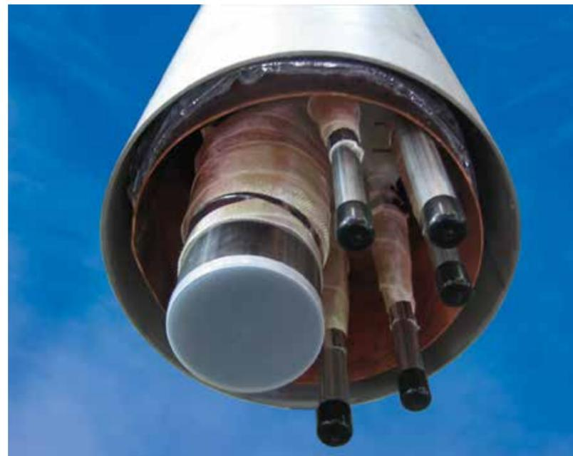
Der Transfer von tiefkaltem flüssigem Helium stellt hohe Anforderungen an die Isolation und die thermodynamische Auslegung.
