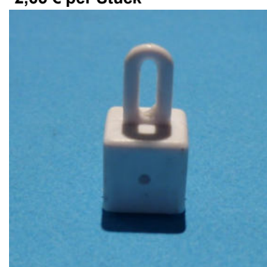
Deckenmagnet weiß, mit Öse Kunststoffgehäuse Abm.: 14 x 13 x 28 mm Haftkraft: 2 kg Art-Nr. 03-140280-05 Verpackungseinheit: 100 Stück 0,79 € per Stück
