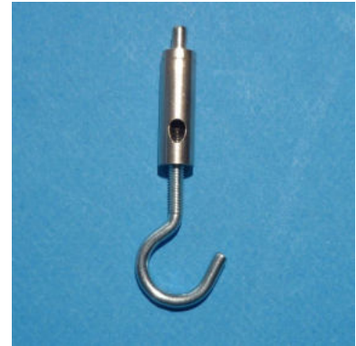
Drahtseilhalter M4 mit Haken messing-vernickelt, Gewinde: M4 für Drahtseile 1,0 bis 1,5 mm \varnothing mit Schraubhaken M4 x 40 mm Art-Nr. 10-104002-03 Verpackungseinheit: 100 Stück 265,00 € per 100 Stück
