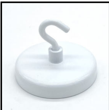
Deckenmagnet weiß, mit Haken eisenummantelt 47 mm ø, Haftkraft: 18 kg Art-Nr. 03-510470-05 Verpackungseinheit: 40 Stück 1,54 € per Stück
