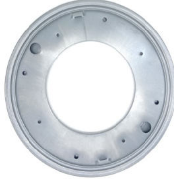
Kugellager 308 mm ø x 8 mm aus verzinktem Stahlblech Innen-ø: 161 mm max. Auflage: 50 - 120 cm ø max. Belastung: 450 kg Art-Nr. 05-300300-04 25,05 € per Stück
