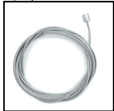
Stahldrahtseil 1,5 mm ø, 1,5 m lang, einseitig mit Nippel für Deckenclip mit Kappe (Art.-Nr. 01-600045-05) Art-Nr. 01-600049-01 Verpackungseinheit: 10 Stück 22,40 € per 10 Stück
