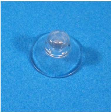
Haftsauger 20 mm ø , transparent mit Knopf-ø: 8 mm, Hals-ø: 4 mm Art-Nr. 01-321200-11 Verpackungseinheit: 100 Stück 13,30 € per 100 Stück
