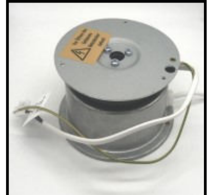
Drehbühne 10 kg Tragkraft Zinkgehäuse, Drehteller: 124 mm \varnothing Gehäusedurchmesser: 130 mm Gesamthöhe: 72 mm Drehzahl: 2,5 U/Min. (rechtsdrehend) Betriebsspannung: 220 - 240 V mit Schleifkontakt für Stromübertragung max. 4 Ampere (bis 900 Watt) Art-Nr. 05-009226-08 150,80 € per Stück
