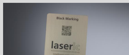
Bildbeispiel: Black Marking von natur-eloxiertem Aluminium. Die Markierung befindet sich zwischen der Eloxal-Schicht und dem Grundmaterial Aluminium.
