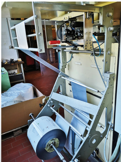
Folienzufuhr zur Verpackungsmaschine
