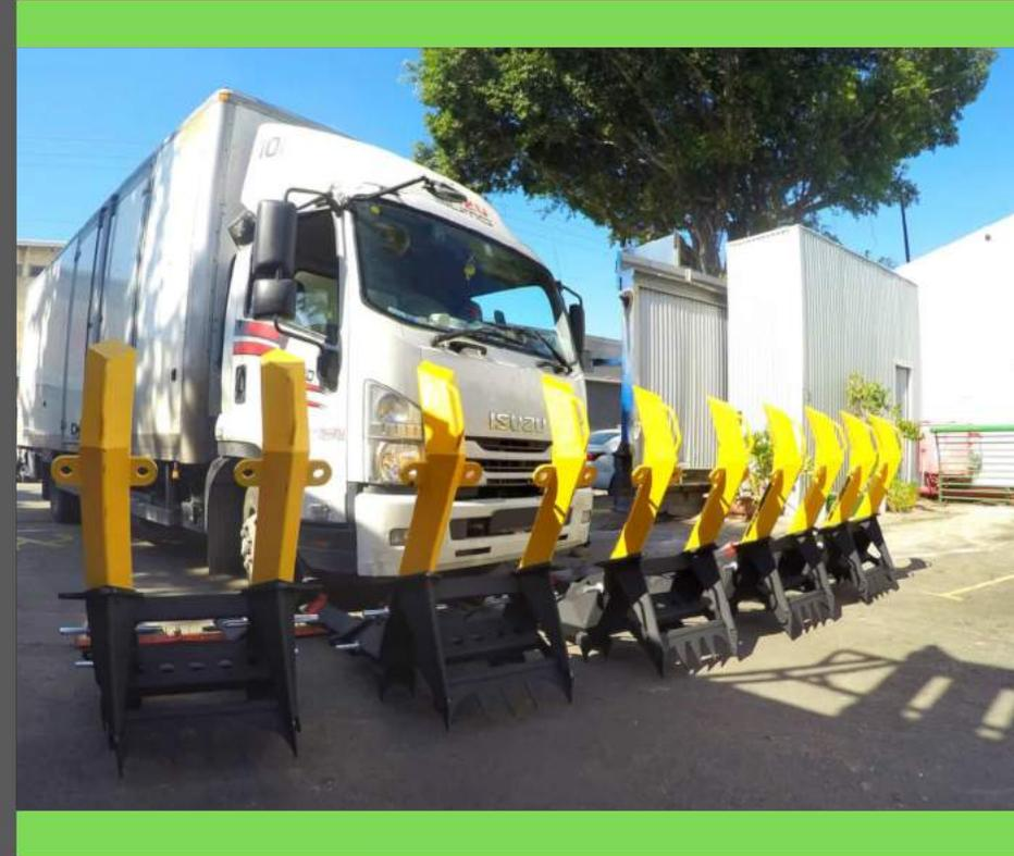
Die HERCULES 100 ist eine mobile Barriere, welche die Stosskraft von Fahrzeugen auf den Boden überträgt und somit sogar Lkws mit einem Gewicht von bis zu 18 t aufhält. Dabei kann sie auf Asphalt, Schotter, unebenem, felsigem oder sandigem Gelände eingesetzt werden. Die Barriere ist in flexiblen Längen erhältlich und lässt sich so an unterschiedliche Fahrzeug- und Strassengrössen anpassen.
