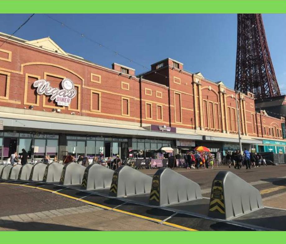
Unser mobiles Absperrsystem ermöglicht den temporären Schutz von Arealen und Zonen vor Angriffen mit verschiedenartigen Fahrzeugen, besonders auch mit schweren Fahrzeugen, wie Lkws und Bussen. Beim Schlagfestigkeitstest IWA 14 wehrte es beispielsweise sowohl ein 2.5 t schweres Fahrzeug mit 48 km/h als auch ein 7.2 t schweres Fahrzeug mit 32 km/h erfolgreich ab.
