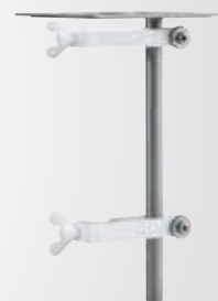
Halterung Ubbelohde-Viskosimeter für Visco 3 (Best.-Nr. 9586)
