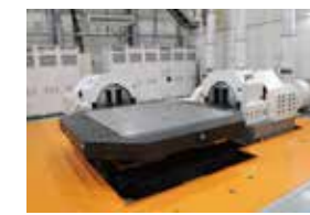
3-Achs Schwingprüfsystem für Erdbbensimulation
