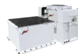
Das weltweit größte 350 kN Schwingprüfsystem mit einem Gleittisch
