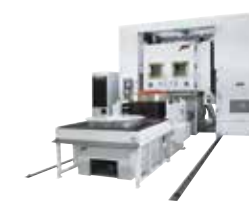
Kammer kombiniert mit einem Schwingprüfsystem mit Gleittisch
