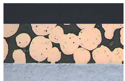
Abb. 9: Beschaffenheit der Gleitfläche am Ende der Lebensdauer
