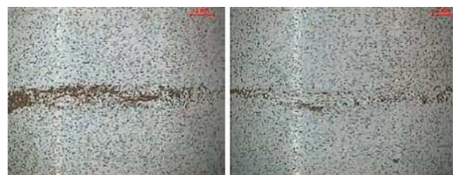
Abb. 36: Schaden durch Erosion in der Einlaufschicht P1-Gleitlager
