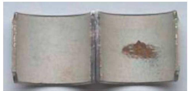
Abb. 35: Örtlicher Schaden durch Kavitation
