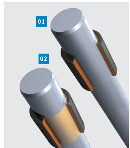
Abb. 6: Materialübertrag 01 Ausgangszustand 02 Ende Einlaufvorgang
