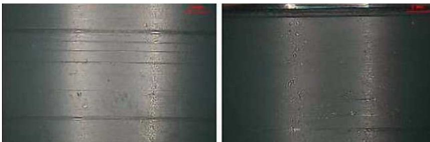
Abb. 37: P2-Gleitlager, Riefen in der Lauffläche
