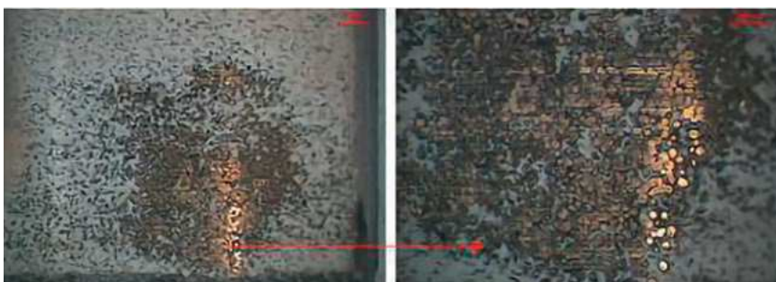
Abb. 38: Örtlich starker Verschleiß durch Montagefehler
