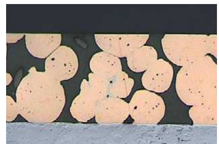
Abb. 8: Beschaffenheit der Gleitfläche innerhalb der Lebensdauer
