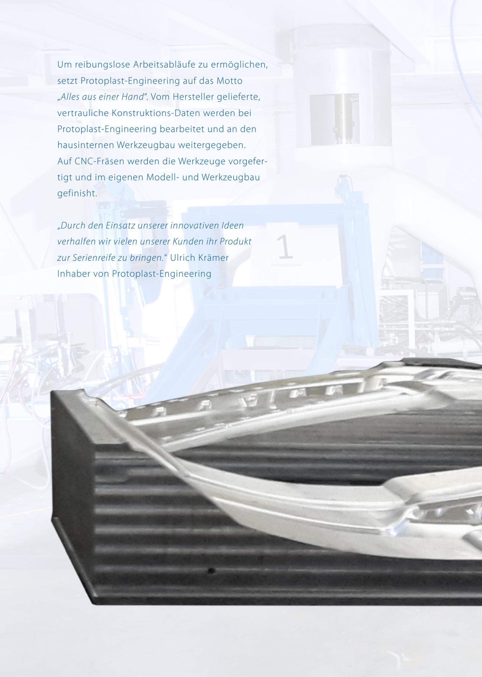
Um reibungslose Arbeitsabläufe zu ermöglichen, setzt Protoplast-Engineering auf das Motto „Alles aus einer Hand“. Vom Hersteller gelieferte, vertrauliche Konstruktions-Daten werden bei Protoplast-Engineering bearbeitet und an den hausinternen Werkzeugbau weitergegeben. Auf CNC-Fräsen werden die Werkzeuge vorgefertigt und im eigenen Modell- und Werkzeugbau gefinisht.
