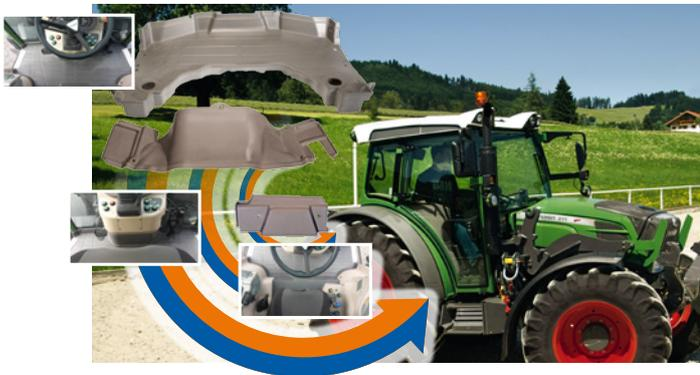
Einige Schlepper-Serien von Fendt werden mit Bodenmatten von Protoplast-Engineering bestückt. Hier die Bauteile mit der die 200er Serie auszustatten wird.
