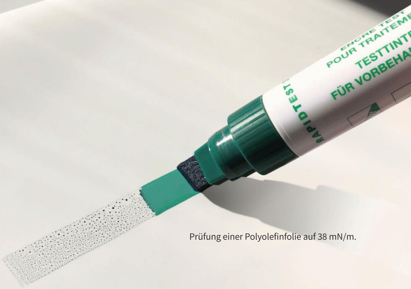
Prüfung einer Polyolefinfolie auf 38 mN/m.
