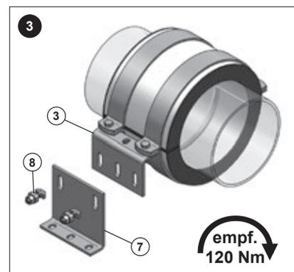
3.) Fußteil (7) mittels Hammersperrkopfschrauben (8) an das Seitenteil (3) anbringen. Gewünschte Höhe einstellen und mit einem Drehmoment von 120 Nm anziehen. Gesamte Konstruktion auf passenden Untergrund (z. B. C-Profil-Schiene, Centum usw.) befestigen.
