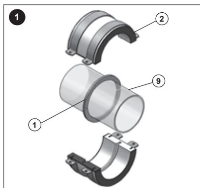
1.) Kältefestpunkt Innenhalbringe (1) auf Stahlrohr (9) anschweißen.
