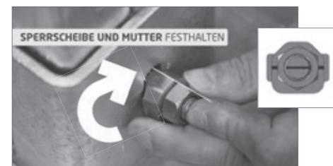
Hammersperrkopf um 90° drehen (Markierungskerbe quer zur Langlochrichtung).
