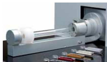
Double-Furnace-Technologie: Probengabe zur Bestimmung von TOC in Feststoffen
