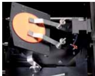
Reflexionsmesseinsatz mit variablem Winkel
