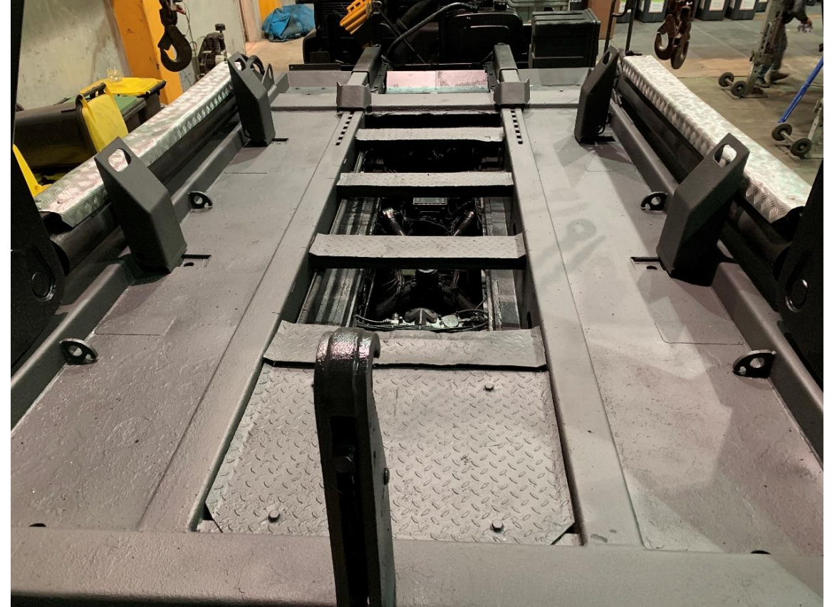
Konservierung auf Wasserbasis Black (UBS Eco)
