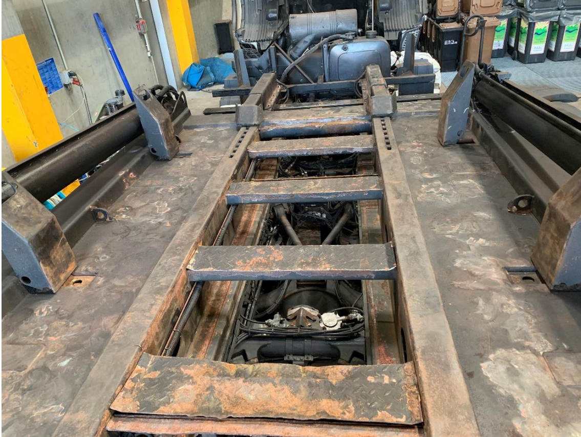
Vorbereitetes Fahrzeug für die Konservierung (Wäsche und Entrostung)
