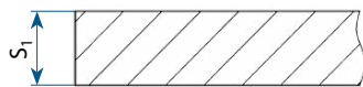
Glatte Dichtfläche Form AA, unbearbeitet oder Dichtleiste Form BB sealing surfaces Form AA, unfinished or Form BB
