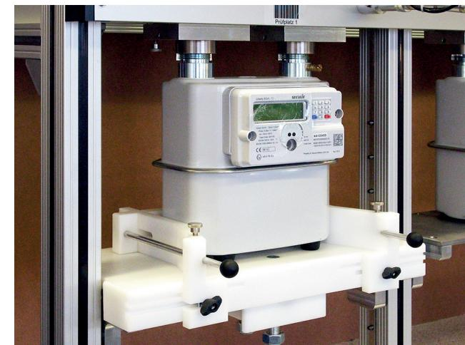
Industriegaszähler. Die konstruktive Ausführung der Vorrichtungen ermöglicht die Spannung von Zählern unterschiedlichster Bau- und Anschlussgrößen. Dies beinhaltet auch benötigte Zähleranbauten, wie Ein- und Auslaufstrecken oder Strömungsgleichrichter. Das Angebot erstreckt sich auch auf die Nachrüstung bestehender Prüfeinrichtungen der Firma inotech oder anderer Hersteller.
