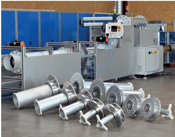
Schnelle Spannung mit dem Revolver-Modell für maximal 5 Nennweiten bis DN150
