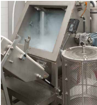
Strahl-Anlage mit Stickstoffkühlung
