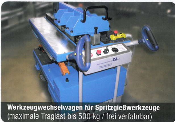
Werkzeugwechselwagen für Spritzgießwerkzeuge (maximale Traglast bis 250 kg)
