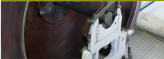
Durch unsere langjährige Erfahrung haben wir uns ein Richt- und Wuchtverfahren angeeignet mit welchem wir ihren Rotor schnellstmöglich und preiswert reparieren können. Beschädigte Rotoren werden bei uns im Hause zunächst gerichtet und anschließend gewuchtet. Neue Rotoren oder Walzen werden direkt gewuchtet.
