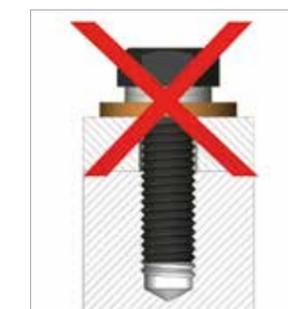
Keine Sicherungsfunktion in Kombination mit frei rotierenden Unterlegscheiben
