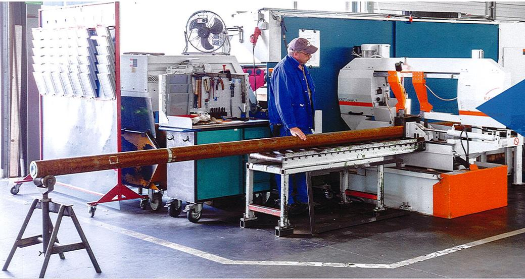
**sägen** Das Sägen der verschiedenen Materialien gehört zu unserer täglichen Routine. Wir sägen bis zu einer Materiallänge von 13 Metern mit modernen KASTO-Sägen.
