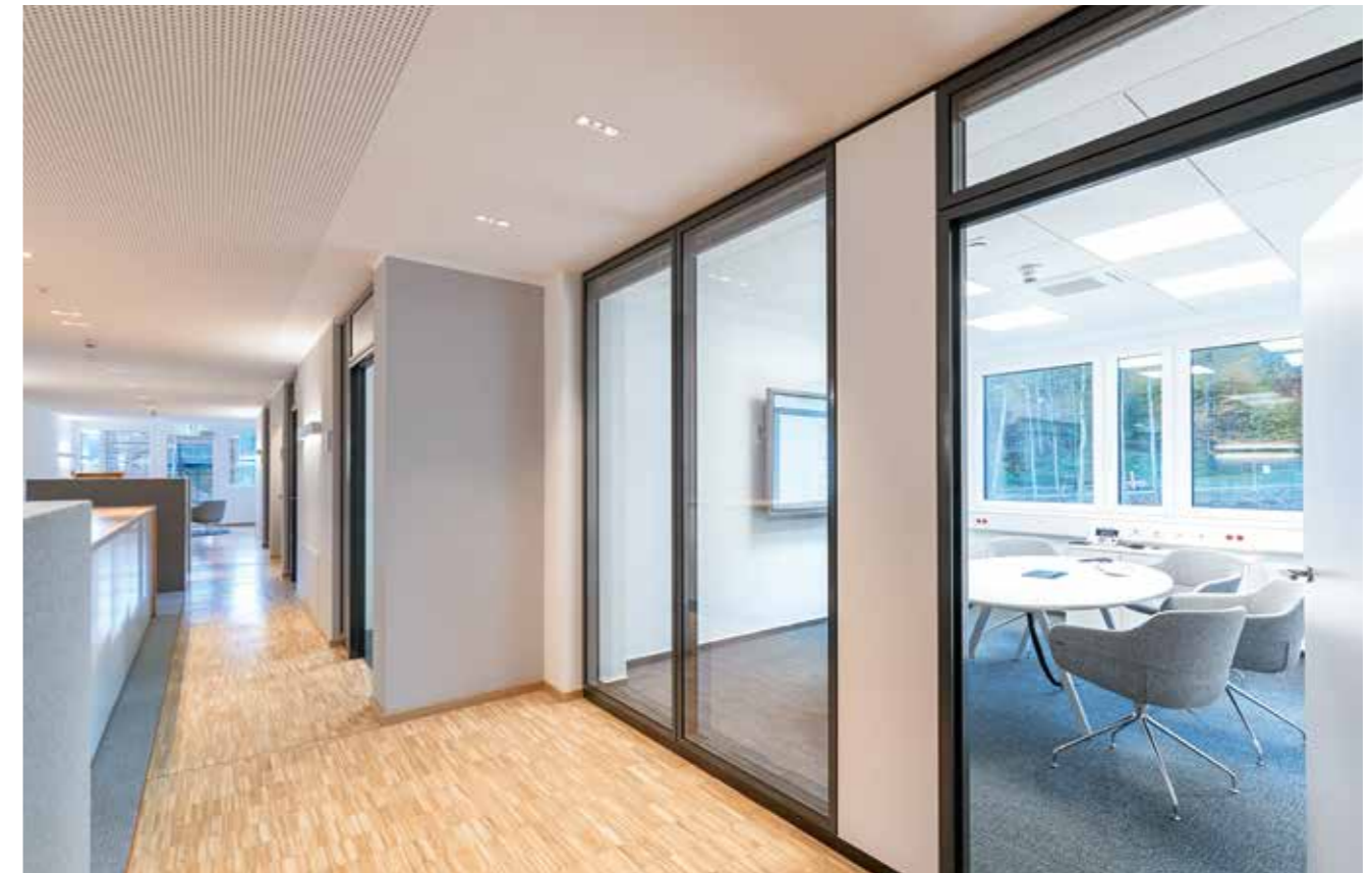
Glastrennwände mit innenliegenden Lamellen-Jalousien.
