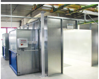
Großraumpulverkabine mit vertikaler Luftströmung für die Beschichtung großer Teile.
