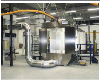
Durchlauf-Pulverkabine für Hand- oder Automatikbetrieb, im Verlust- oder Rückgewinnungsverfahren.
