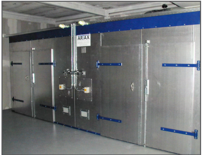
Abb. oben > Pulvereinbrennofen mit Schiebetüren
