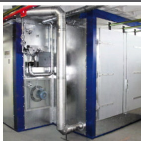
Konvektionsöfen Pulvereinbrennöfen, Lacktrockner, Haftwassertrockner als Kammer- oder Durchlauföfen.
