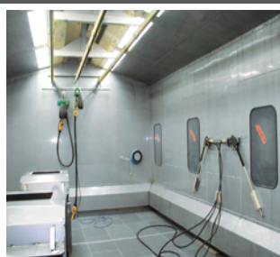
Vorbehandlungsanlagen im Durchlauf- oder Taktverfahren, Reinigungskabinen für die manuelle Vorbehandlung der Teile.
