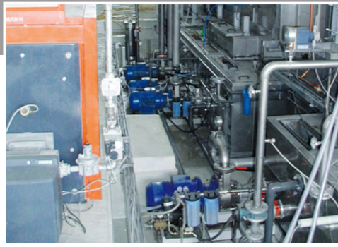
Kammer-Vorbehandlungsanlage mit 5 Zonen für Stahl- und Aluminiumteile.
