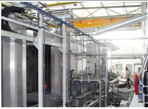
Kammer-Vorbehandlungsanlage mit 5 Zonen für Stahl- und Aluminiumteile.
