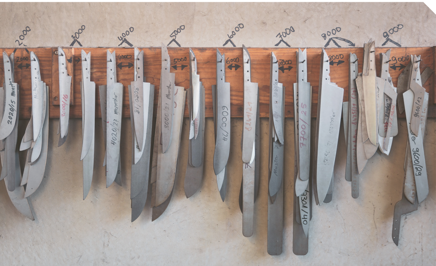
Oben Hochwertige Klingenrohlinge aus Chrom-Molybdän-Stahl in insgesamt mehr als 2.000 Ausführungen.
