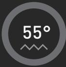
Whitworth Gewinde nach DIN 11
